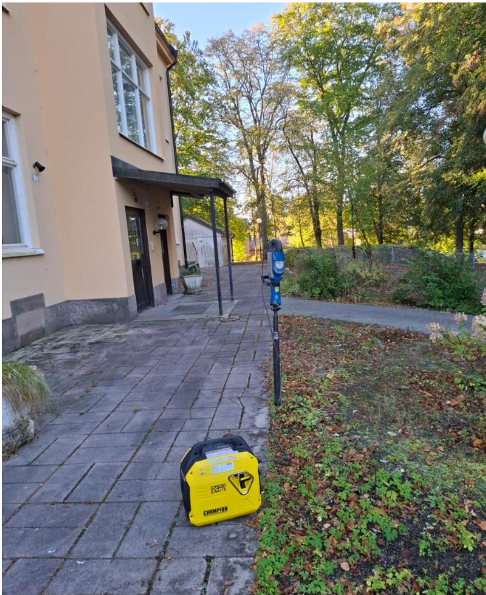
Figur 2 Provtagning med slagbormaskin och genomströmningsprovtagare.
