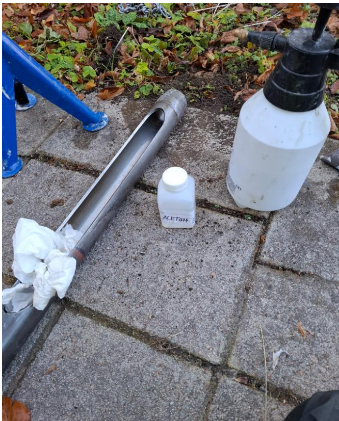
Figur 4 Rengöring av provtagningsutrustning med acetone.
