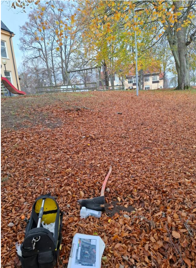
Figur 5 Ytprov november 2024. Handprov med fyllhammare.
