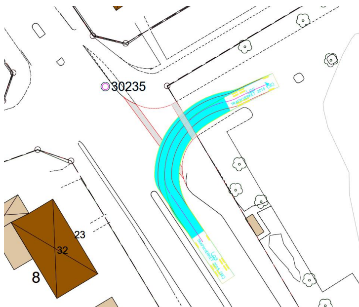
Figur 9. Förslag på ny utformning av in- och utfarten till planområdet från Norra Kringelvägen samt körspår med en sopbil
