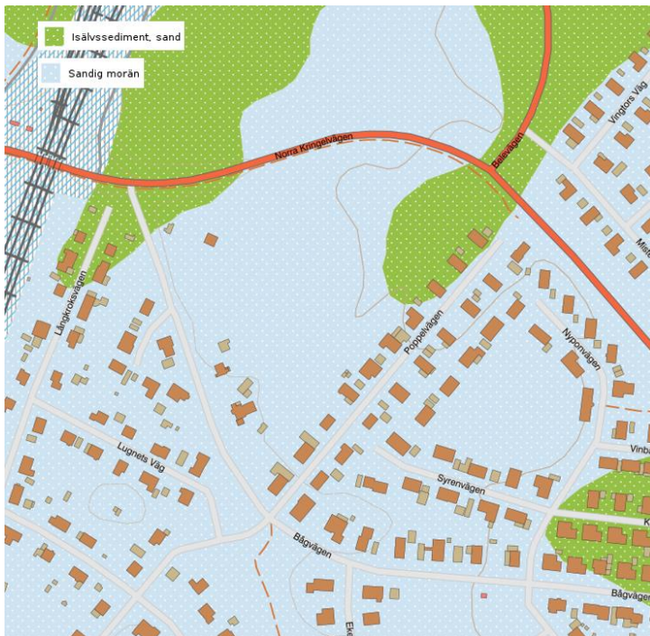
Figur 9. SGU:s Jordartskarta för Bågvägen (SGU, Jordartskarta, [2022-01-20]). Det ljusblå området med vita prickar symboliserar sandig morän och de gröna områdena med vita prickar står för isälvs sediment, sand.
