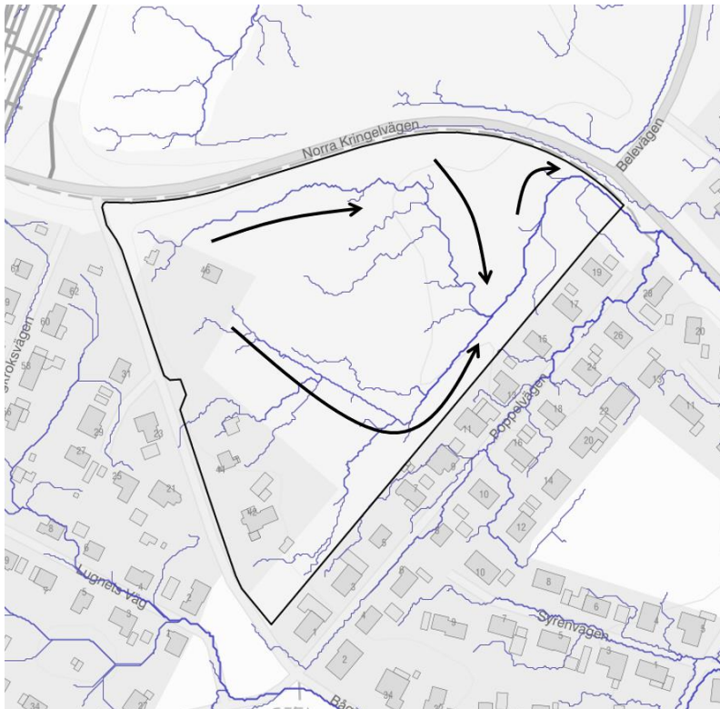
Figur 14. Rinnvägar som motsvarar en avrinningsyta på minst 500 m 2 , koncentrerat på planområdet för utredningen (Scalگو Live, 2022, [2022-01-20])
