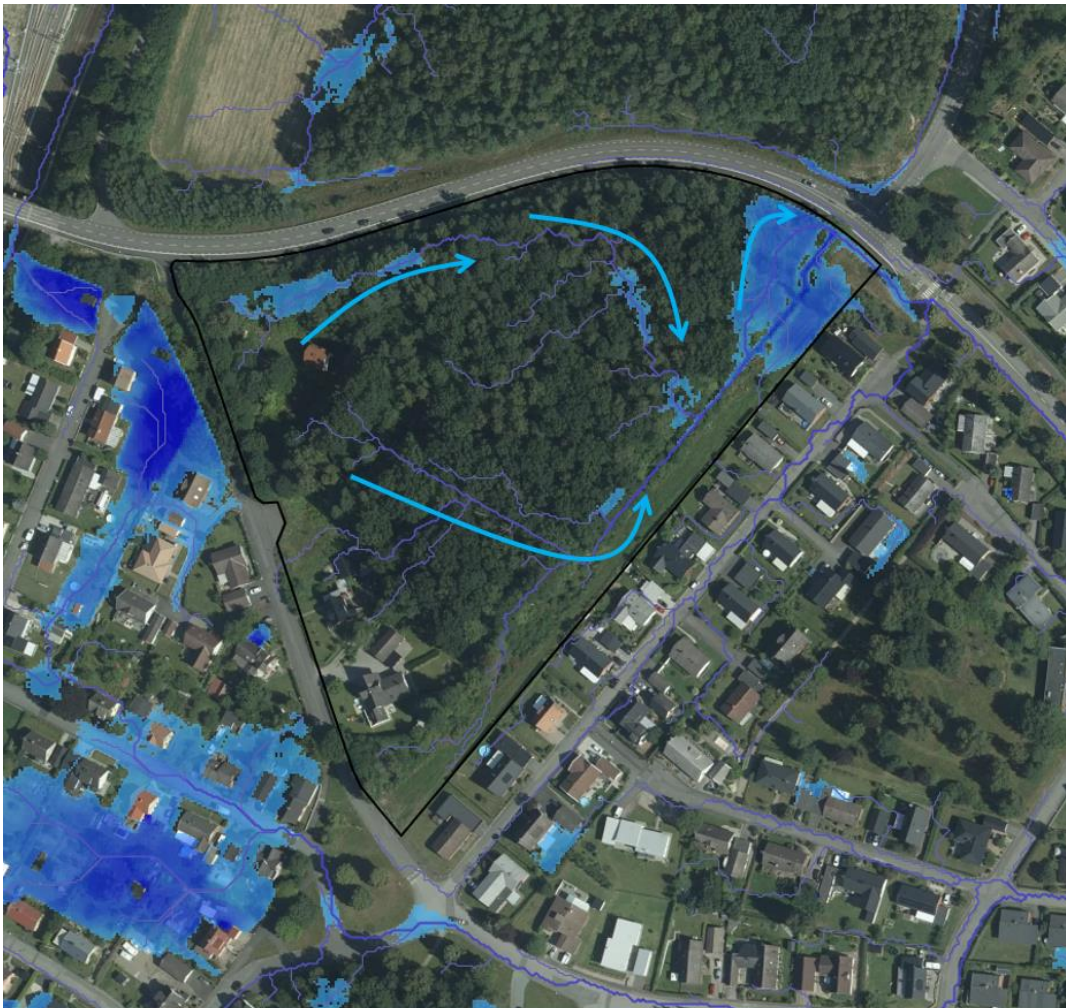
Figur 18. Rinnvägarna som går genom Bågvägen och översvämningarna som bildas vid ett 1h skyfall.
