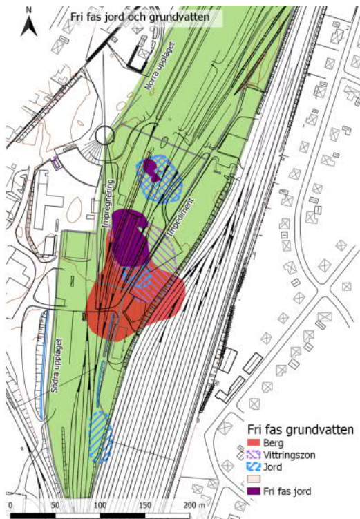
Figur 10. Områden där spridning av PAH med fri fas i jord och grundvatten indikeras. Källa: HIFAB AB, 2019-06-25
