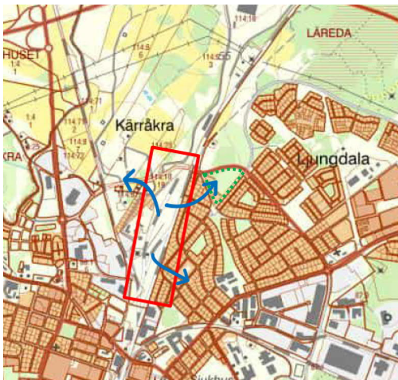
Figur 8. F.d impregneringsanläggningen är markerat i rött. Blåa pilar visar ungefärlig strömningsriktning för grundvattnet från olika delar av området. Det aktuella detaljplaneområdet är markerat i grönt. Källa: Liljemarks Consulting, 2021-05-03 (rev. 2022-05-14)
