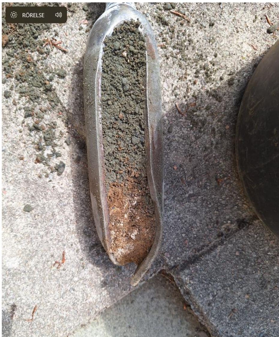
Figur 13 Fyllnadsmaterial av grå sandigt grus som överlagrar en brun sandig morän.
