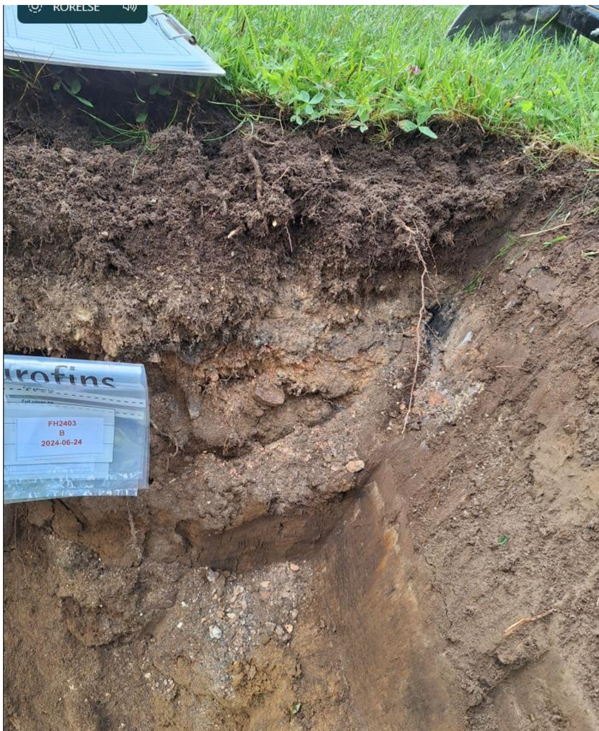
Figur 10 FH2403. Under matjorden finns ett decimetertjockt lager med tegelförande sandigt grus.
