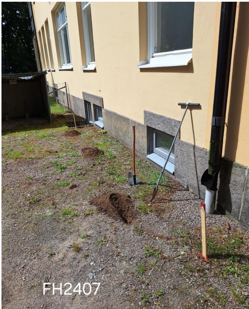
Figur 3 Handhållen provtagning av ytlig jord med spadborr på grusyta.
