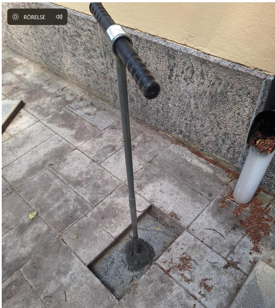
Figur 6 Handhållen provtagning med spadborr under betongplatta.
