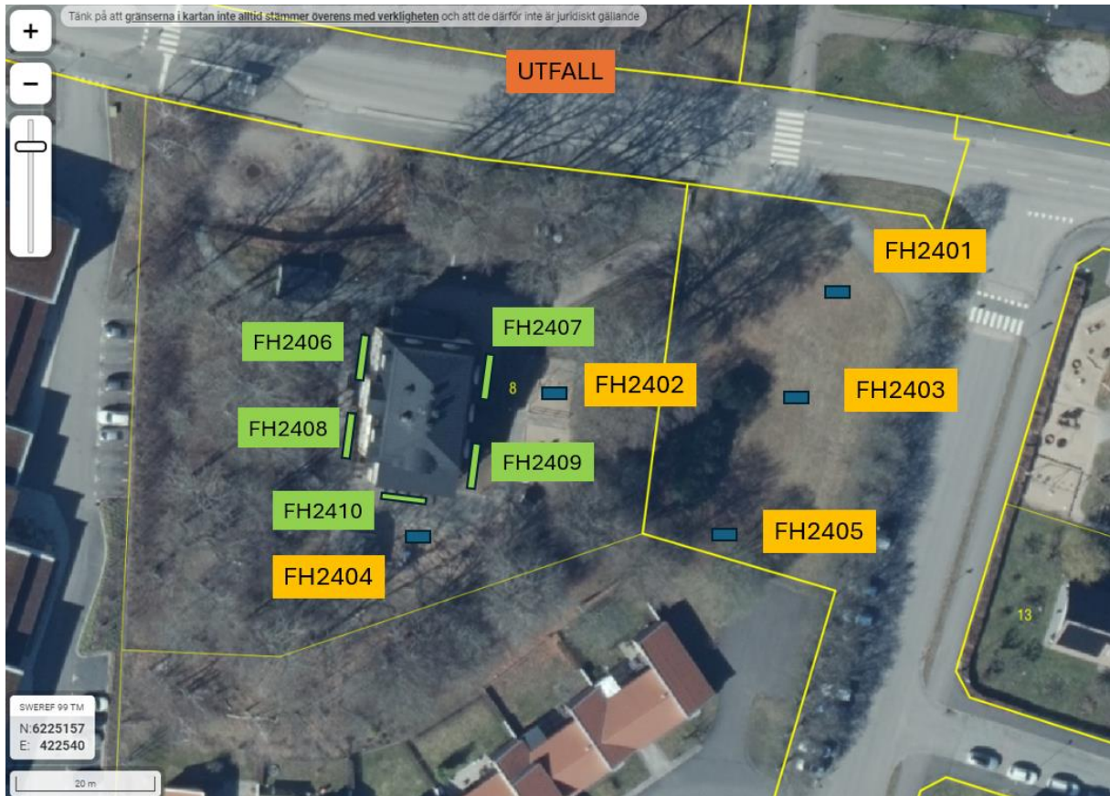
Figur 8 Placering av maskingrävda provgropar (FH2401-FH2405) och samlingsprover av ytlig jord för PCB-analys (FH2406-FH2410).
