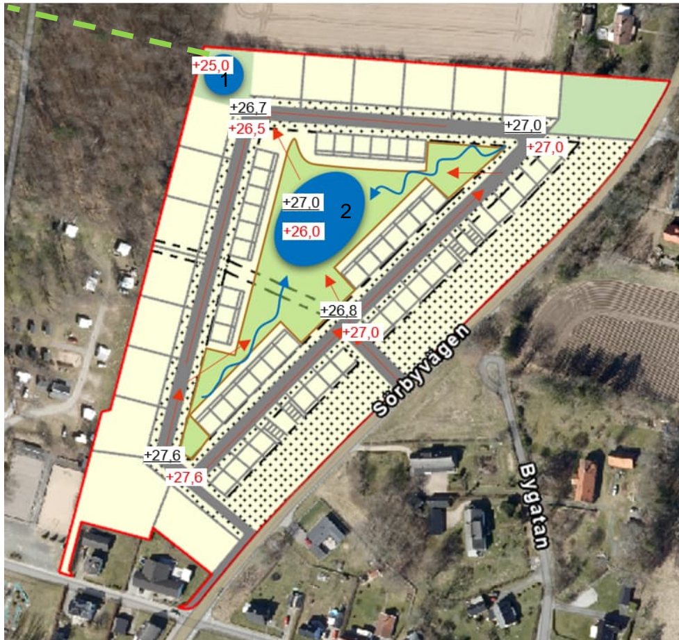
Figur 15. Principalskiss med föreslagen höjdsättning med avrinning till de centrala och nordvästra delarna av utredningsområdet. Svarta understrukna höjder redovisar ungefärlig marknivå i dagsläget. Röda höjder redovisar föreslagna nivåer i denna utredning. Grön streckad linje visar föreslagen anslutning till Vinslövssjön.
