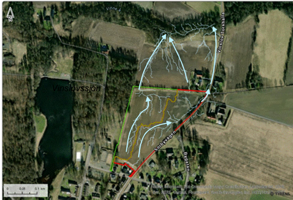
Figur 6. Utredningsområdet indelat i befintliga avrinningsområden med flödesvägar till Vinne å. Flödespilar visas i mörkblått och ungefärligt läge för befintlig fastighet i lila.
