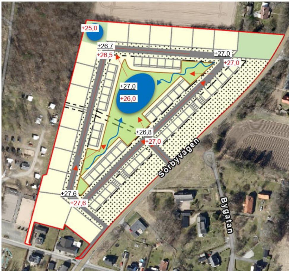
Principskiss med föreslagen höjdsättning med avrinning till de centrala och nordvästra delarna av utredningsområdet. Svarta understrukna höjder redovisar ungefärlig marknivå i dagsläget. Röda höjder redovisar föreslagna nivåer i denna utredning.
