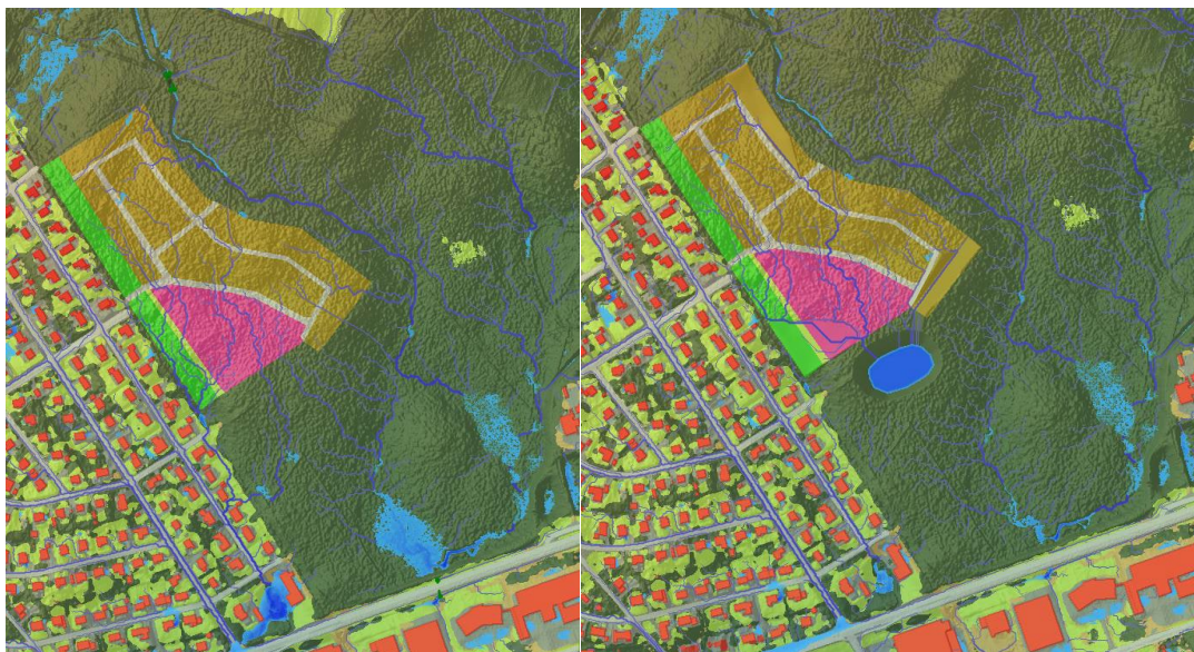
Figur 4: T.v. Utformning av planområdet med befintliga avrinningsvägar. T.h. Utformning med avrinningsvägar mot föreslagen fördröjningsyta (TerrVia 2024). Observera att bilderna utgår från samrådsförslaget.
