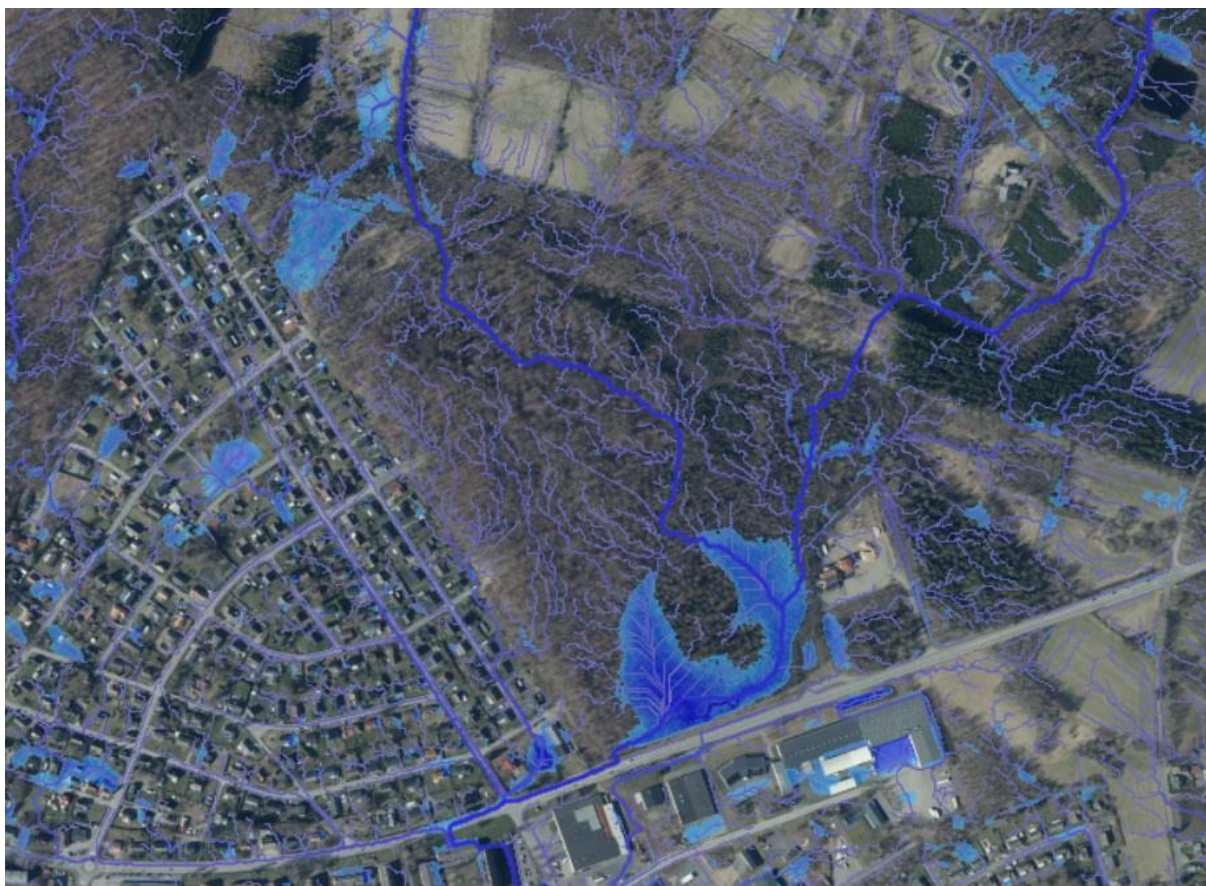
Figur 10. Befintlig situation 100 års regn klimatfaktor 1.3 (bild hämtad från SCALGO Live).
