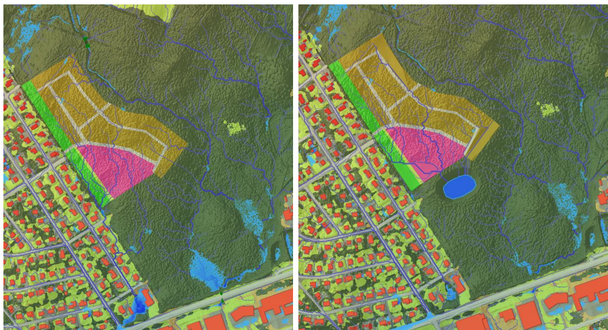
Figur 12. T.v. Utformning av planområdet med befintliga avrinningsvägar, notera ansamlingar nedströms. T.h. Utformning med avrinningsvägar mot föreslagen fördröjningsyta, notera positiv påverkan på lågpunkter nedströms.
