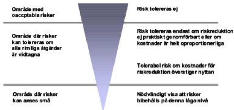
Figur 1. Princip för uppbyggnad av riskvärderingskriterier (Räddningsverket, 1997).
