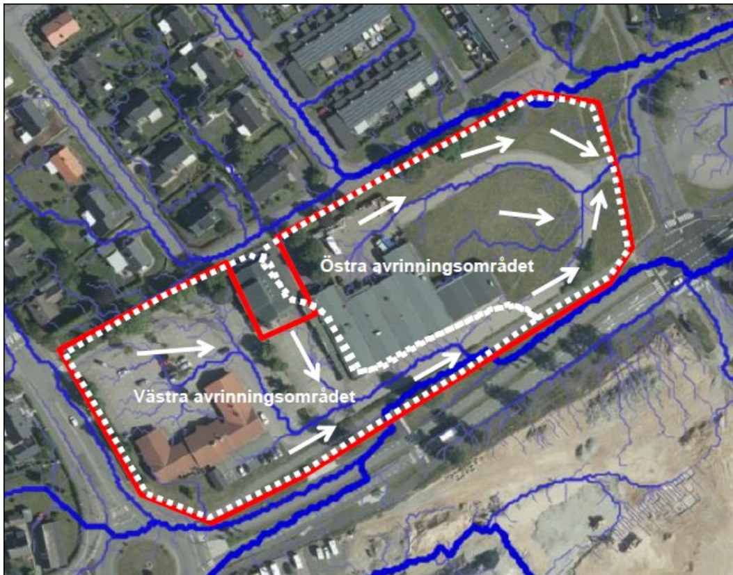
Dämnet 11 kan delas in i två avrinningsområden (ScalcoLive, 2022). Pilarna visar dagvattnets rinnriktning på ytan innan exploatering.
