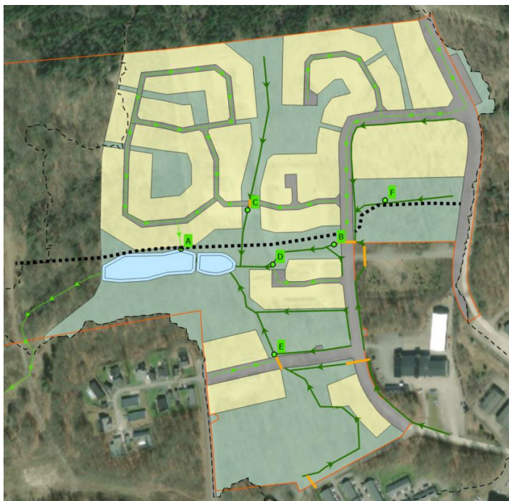
Figur 20. Föreslagna utlopp för nytt dagvattennät till diken. Observera att diken och trummor visas principiellt. Längder och bredder på dessa redovisas inte i figuren.
