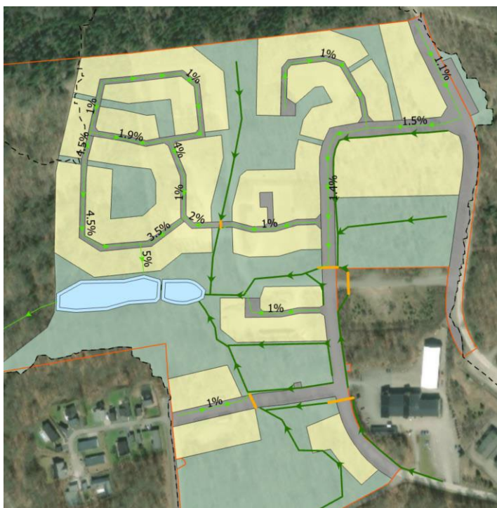
Figur 22. Föreslagna ledningars antagna lutningar.
